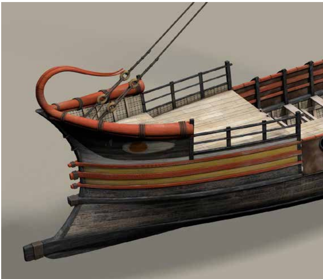
Fig. 4. Pièce de quille prolongée au-delà des élancements de la proue d'une pentekontore .
